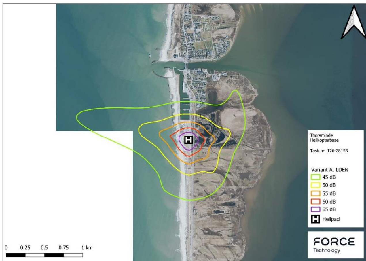
Figur 3. Støjkonturer af helikopterflyvning med anvendelse af tre flyvekorridorer beskrevet ved Variant A. Den gule kontur angiver et støjniveau på L_{DEN} 50 dB(A) svarende til grænseværdien for en almen flyveplads med regional vigtighed. (Kopi fra miljøkonsekvensrapporten, Kilde: Force Technology).
