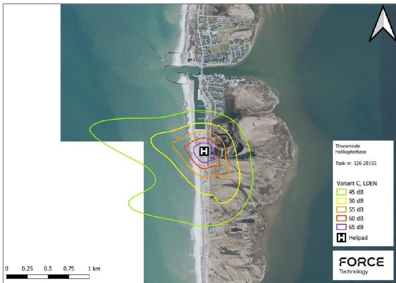
Figur 5. Støjkonturer af helikopterflyvning med anvendelse af to flyvekorridorer beskrevet ved Variant C. Den gule kontur angiver et støjniveau på LDEN 50 dB(A) svarende til grænseværdien for en almen flyveplads med regional vigtighed. (Kopi fra miljøkonsekvensrapporten, Kilde: Force Technology).
