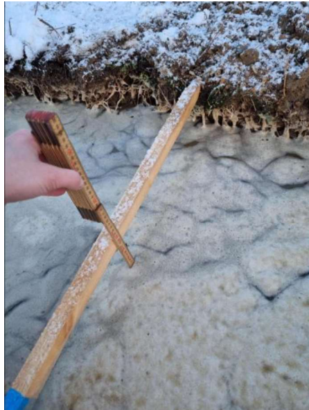
Figur 4 - Opmåling af vandets dybde ved start af nedsivning forsøg
